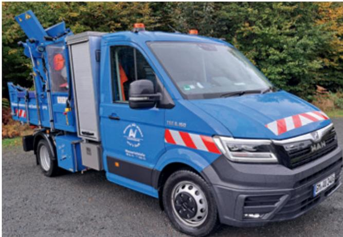
Abb. 58 a und b: Sinkkastenwagen
