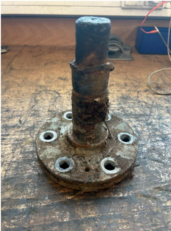
Abb. 33: alte Fußlagerwelle (Vollansicht)
