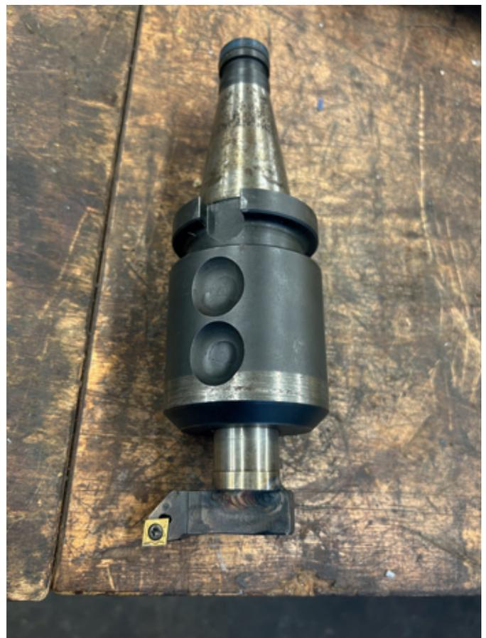
Abb. 39: selbstgebauter Fräser
