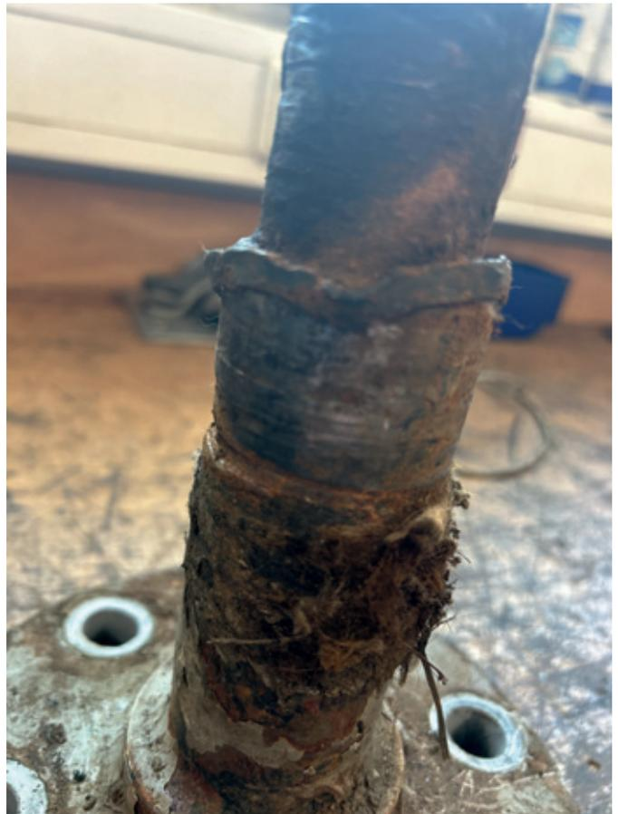
Abb. 34: alte Fußlagerwelle (Nahansicht)
