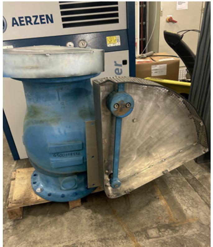
Abb. 43: instandgesetzte RS-Klappe
