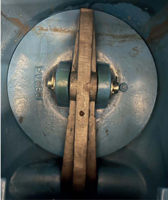
Abb. 40: neuer Klappenarm (Draufsicht)
