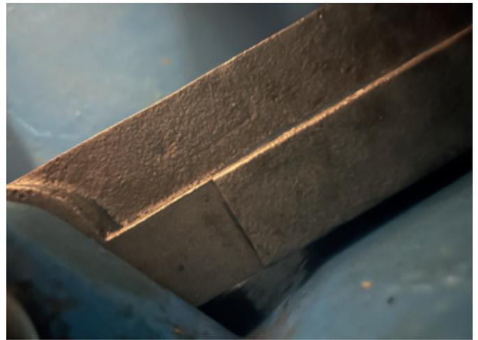
Abb. 41: neuer Klappenarm (Nahansicht der Nuten)
